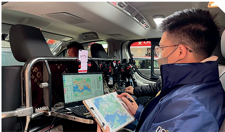
通訊辦職員實地測試一家流動網絡營辦商的網絡覆蓋，以核實該營辦商是否符合關於提供5G網絡及服務的牌照要求。
